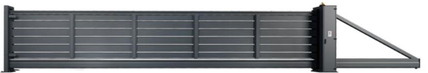
NOVITÀ Riempimento orizzontale in lamiera con spessore di 1 [mm] con gioco di 20 [mm] tra i pannelli (modello di riempimento residenziale).
