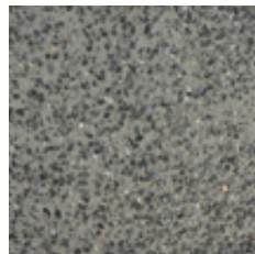
IT Deco Ghiaino: incolore Cemento: grigio Graniglia: spaccato 9-12 mm 100% grigio carnico EN Cement: gray Aggregates: broken 9-12 mm
