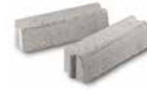
Modulo ribassato per passaggio pedonale Disponibile nei colori grigio e testa di moro. 60 pz per pallet. Reduced module for pedestrian crossing Available in grey and dark brown colour Dimensioni - Dimensions 500 X 120/150 X h 150 mm
