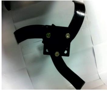
При сборке последующих монтажных площадок тщательно позиционируйте одноименные ножи, поворачивая их друг относительно друга на небольшой угол так, чтобы у Вас получилась режущая спираль из одноименных ножей в виде синусоиды. Это позволит входить ножам в землю поочередно, обеспечивая плавность хода при культивации.
