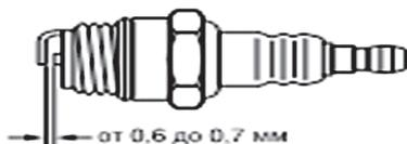
4. Проверьте состояние уплотнительного кольца каждой свечи, затем вверните свечи рукой, чтобы не допустить срыва резьбы.
