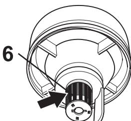
Imukanava (6) on varustettu uimurilla.
