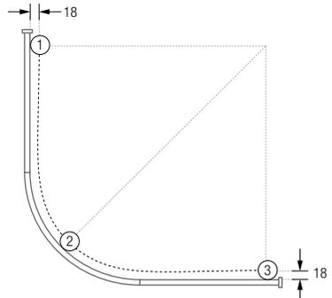
Die Bohrlöcher für die Deckenabhängungen befinden sich auf der Achslinie der Sackbohrungen jeweils 18 mm von der Innenkante der Duschkabine nach innen versetzt.
